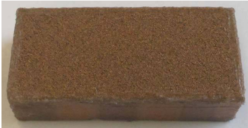
Figura 1. Campione di prova (Suber) dopo trattamento di sigillatura.
