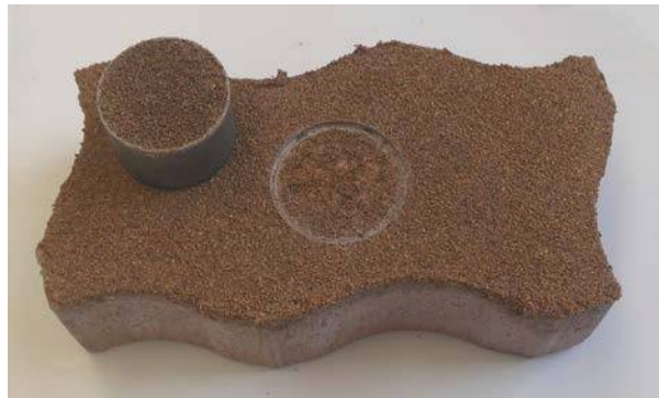
Figura 3. Sezione di rottura post-trazione.
