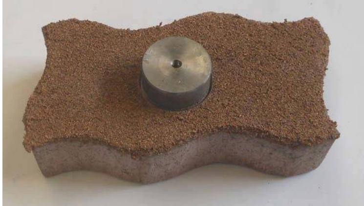
Figura 1. Campione di Suber con tassello metallico pronto per la prova.
