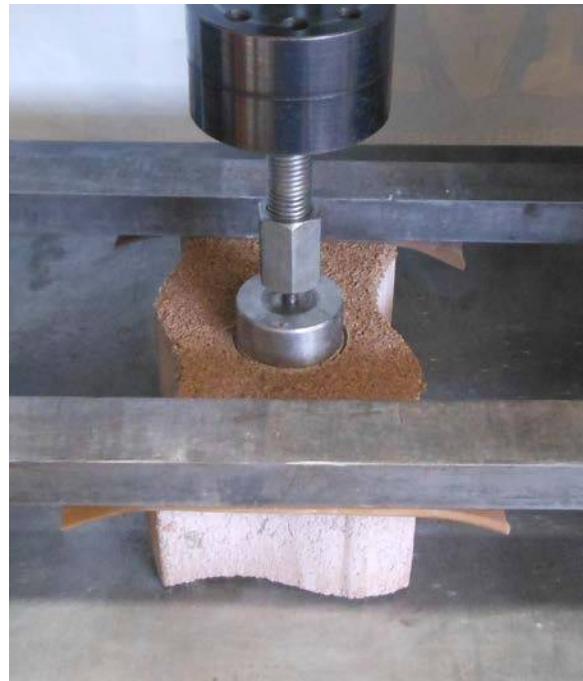
Figura 2. Attrezzatura per la determinazione dell'aderenza al supporto.
